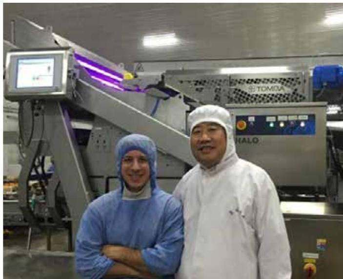
在使用中，康发发现，陶朗的Halo设备是一款灵活高效的分选机，不但能准确分选切条或切半的黄桃白桃，还适用于杏半。此外，此分选机使用和维护非常简便，中文的操作界面简洁直观，且模块化设计便于日常维护保养，能减少维护成本，避免故障性停机对生产带来的影响；Halo还可以实时记录和显示原料数据以及加工处理过程中的信息，帮助企业更好的了解原料情况，准确把控最终产品的品质。
