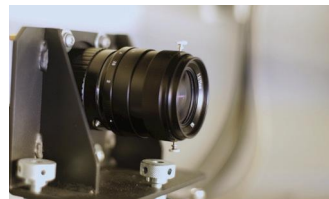
精确剔除微小的颜色和形状瑕疵 双面彩色相机，配合高强度、高聚焦的LED背景光
