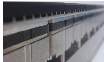
误剔率极低 超高速喷阀与喷嘴直接相连
