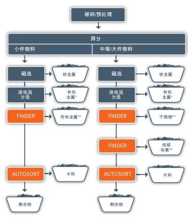
\* 建议采用X-TRACT 和 COMBISENSE 进行分选 \*\* 建议采用AUTOSORT 扫描仪进行进一步提纯
